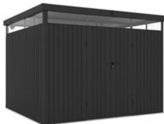
A068776 CASETA METAL LUMEN L7 OROKU Marco estructura de acero zincado 0,6 mm. Chapa galvanizada de 0,40 mm de espesor. Anticorrosión. Luz LED recargable con soporte magnético. Con cerradura de seguridad y llave incluidas. 2 puertas grandes abatibles. Tragaluz 360°. Color: Negro. Puerta: 111,5x181 cm. Exterior: 293x259x218 cm. Interior: 287x249x218 cm. Superficie total: 7,66 m 2 . Peso: 172 kg. 1.011,60€
